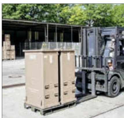
Palettenunterbau vereinfacht das Handling
