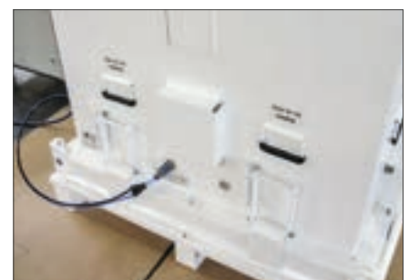
Wasserdampfdichter Behälter bei Dichtheitsprüfung durch Überdruck
